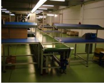
Como solución a las necesidades de industrialización , SAP está implantando “Sistemas convergentes de montaje” , los cuales consisten en : Uno o varios transportadores , los cuales desplazan el producto , componentes , contenedores , etc.. Integrando bancos de montaje a lo largo de la línea , efectuándose las diferentes operaciones de : Mecanizado , ensamblado y verificado .
