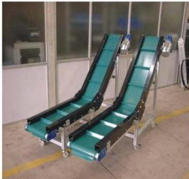
Construidos en PVC , Poliéster y FDA en caso de aplicaciones en alimentación y laboratorios . Especialmente indicados en descarga de inyectoras o alimentaciones de sistemas vibrantes situados en altura .
